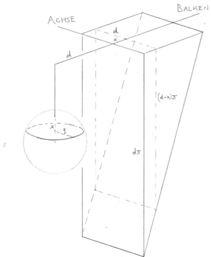
Nach dem Höhensatz ist  $\rho^2 = x(d - x)$  und der Flächeninhalt des Schnittkreises daher  $x(d - x)\pi$ . Da der Mittelpunkt des Schnittkreises sein Schwerpunkt ist, übt er ein Drehmoment der Größe  $dx(d - x)\pi$  aus.
