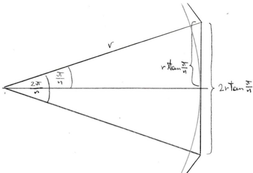
Analog ist der Umfang eines regelmäßigen  $n$ -ecks, das einem Kreis mit Radius  $r$  umschrieben wird,  $2rn \tan \frac{\pi}{n}$ .
