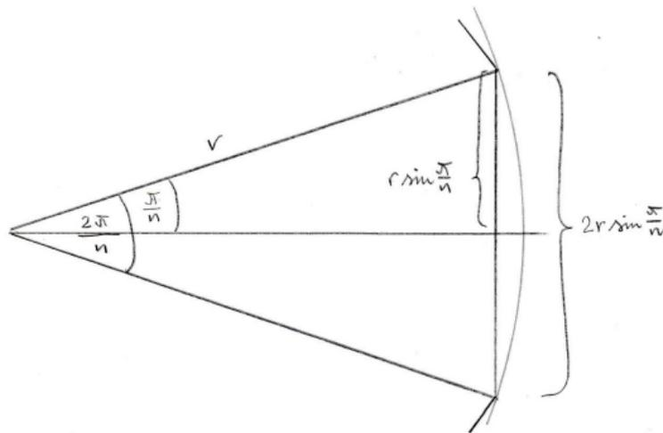
Wie man sieht, ist der Umfang eines regelmäßigen  $n$ -ecks, das einem Kreis mit Radius  $r$  eingeschrieben wird,  $2rn \sin \frac{\pi}{n}$ .
