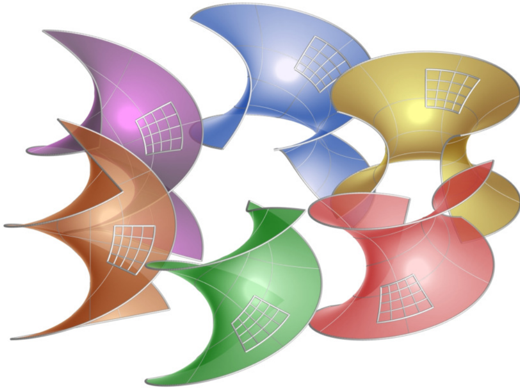
FIG. 6. Eine Variation der Verbiegung einer Wendelfläche (orange) in die Kettenfläche (gelb): Man beachte die Bewegung des hervorgehobenen orthogonalen Gitters – seine Metrik wird nicht verändert!
