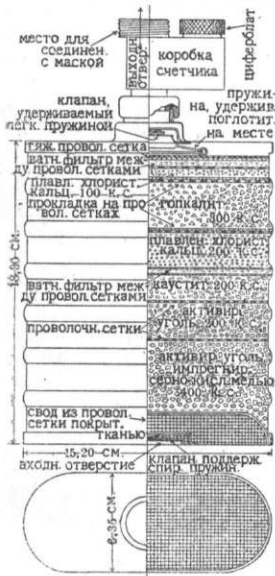
Рис. 5. Детали респираторной коробки противогаза «All-Service».
